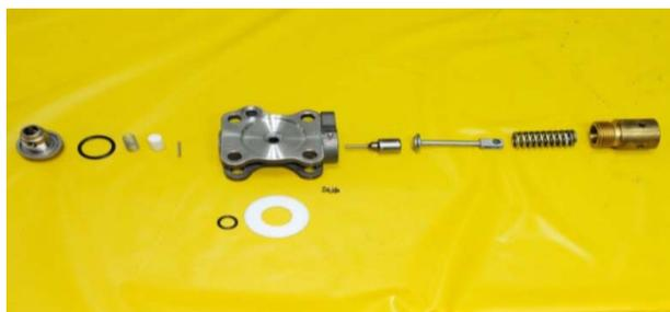
圖 8 氣動式 GCB 電磁閥分解圖示
