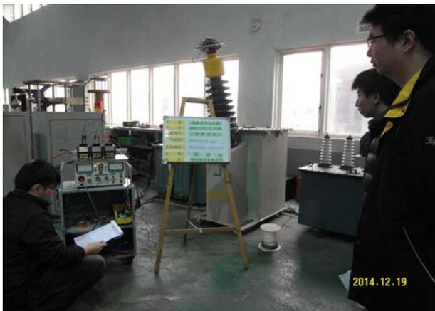
圖 14 (一次側)電力頻率耐電壓試驗
