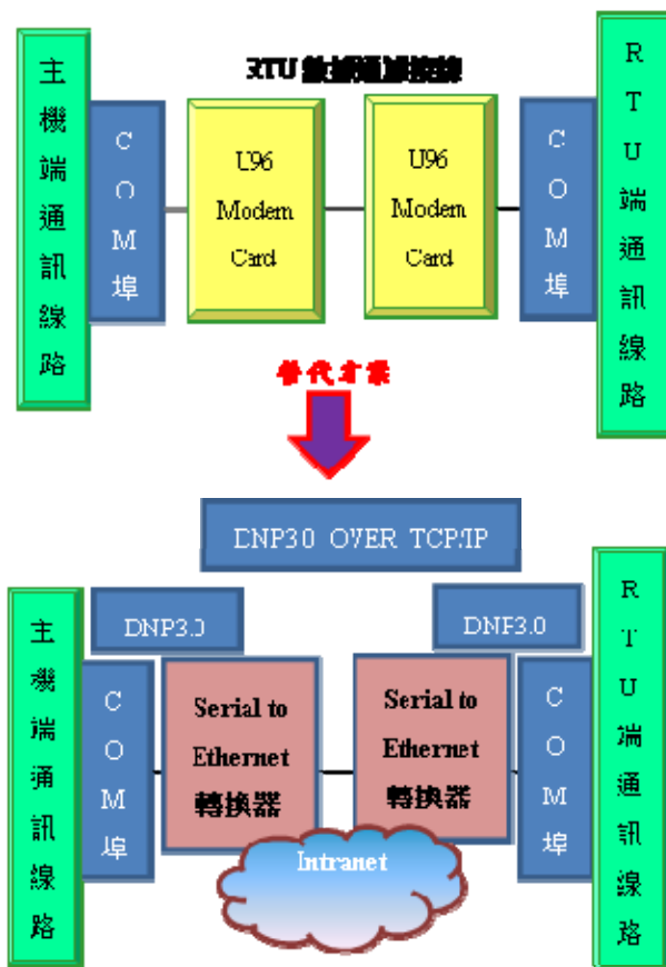
圖 5 RTU 網路 IP 化替代方案架構圖
