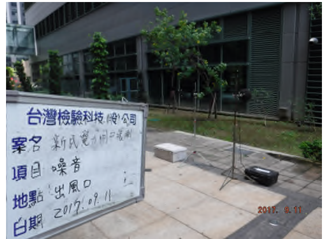
監測項目：噪音 監測地點：出風口 監測時間：2017.09.11
