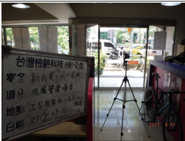
監測項目：低頻噪音 監測地點：工區周界外一公尺以上住宅 監測時間：2017.09.11
