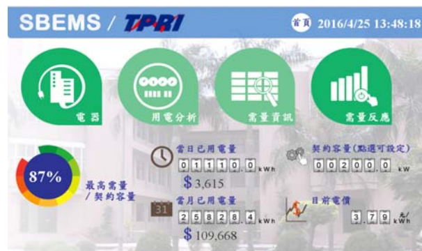
圖 4 智慧建築能源管理系統介面
