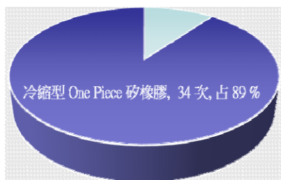
圖 14 事故接續匣材質分析圖
