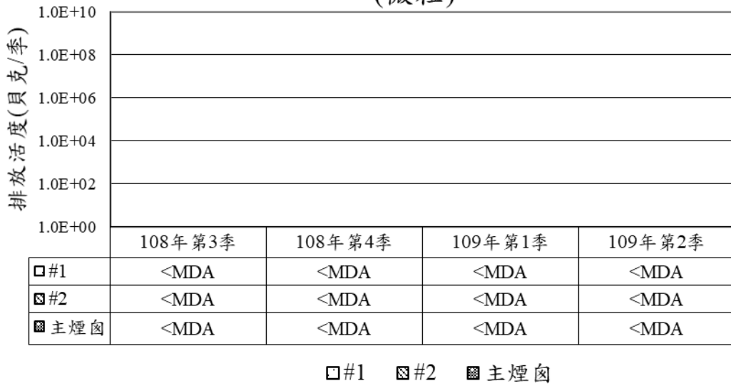
圖三 核能一廠放射性廢氣排放統計圖 (微粒)
