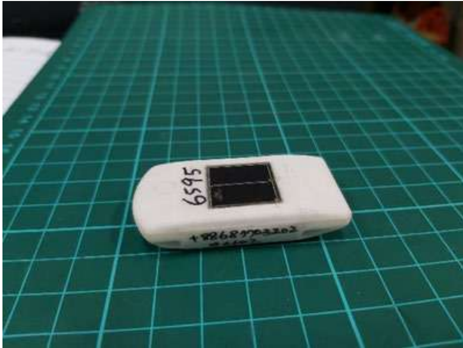
圖 1.4-3 Debut OMNI(3G)太陽能衛星發報器
