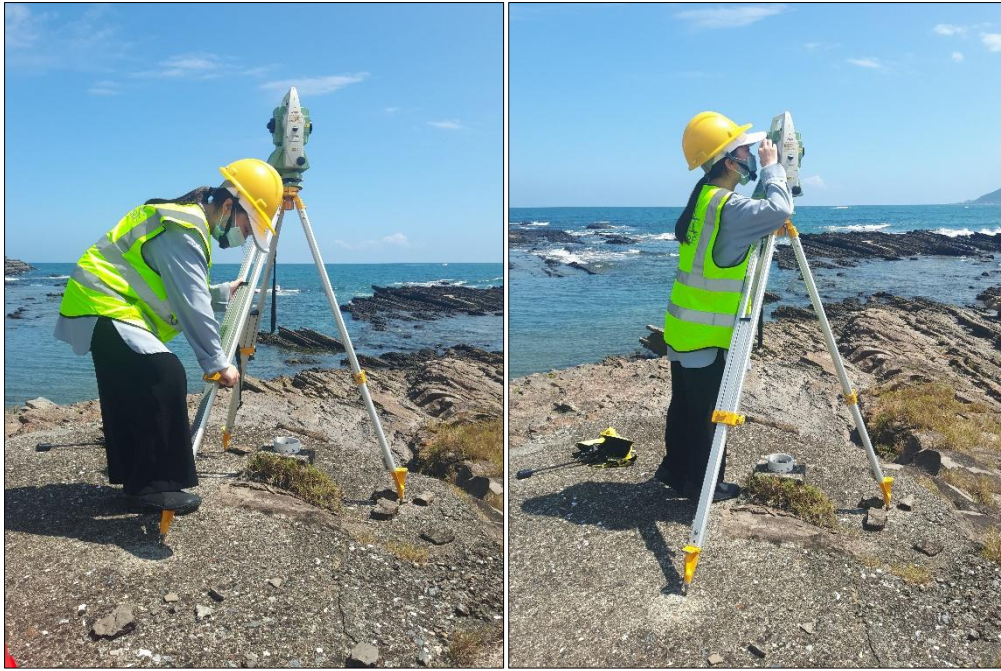
圖 3-2 全站式經緯儀架設於控制點
