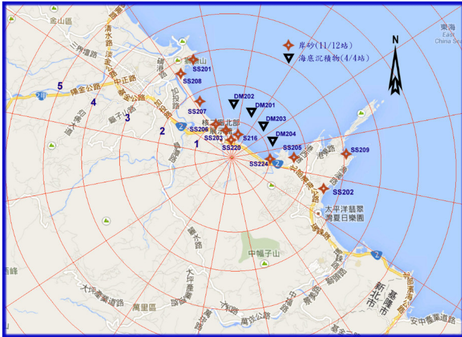
圖 11 核能二廠岸砂取樣站分佈圖(5 公里內)
