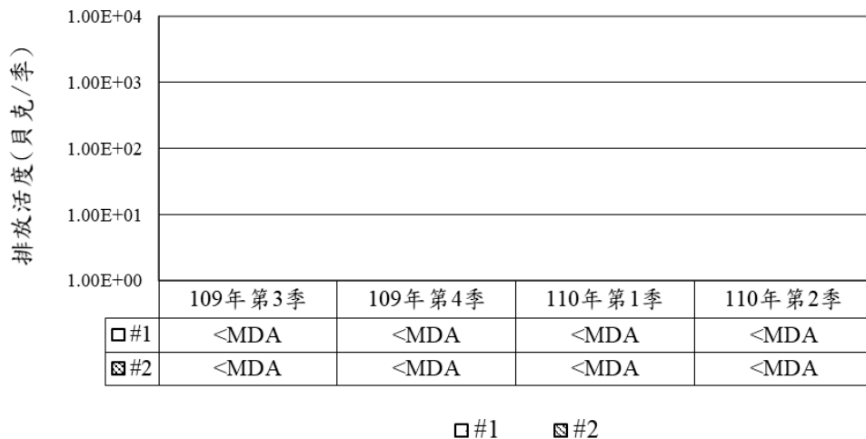
圖五 核三廠放射性廢氣排放統計圖 (氮-13)
